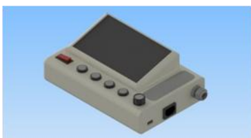
Рисунок 1. 3D-модель спроектированного устройства лечения трофических язв методом вакуумной терапии, построенная в САПР Autodesk Inventor
