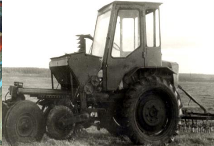
Рисунок 2. Агрегат для опрыскивания и ухода за пастбищами
