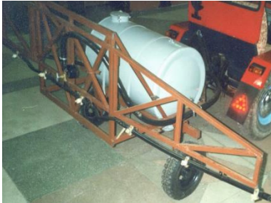
Рисунок 2. Агрегат для опрыскивания и ухода за пастбищами
